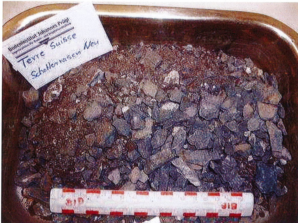
Abbildung 2: Bestandteile des Materials nach Abwaschen des Schlämmkorns < 0,063 mm.
